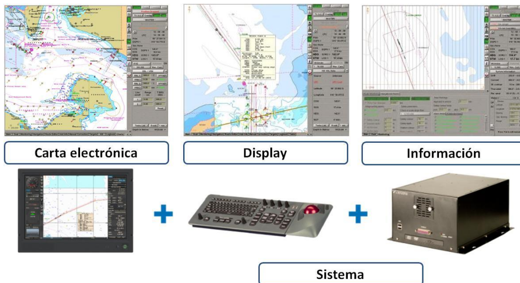
Fig. N° 01-01 El ECDIS: Carta Náutica electrónica, el monitor, la información, el software, teclado/mouse, computador, respaldo, fuente de poder
